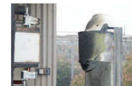
Certificazione GS-ET-29, classe 2, a 7 kA superata: la combinazione delle protezioni per testa e viso protegge l'utilizzatore
