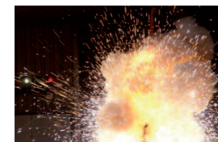
Arco elettrico a 7 kA
