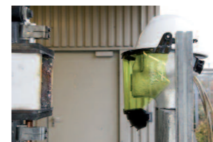
Set MSA di protezione contro l'arco prima del test in spazio delimitato a 7 kA
