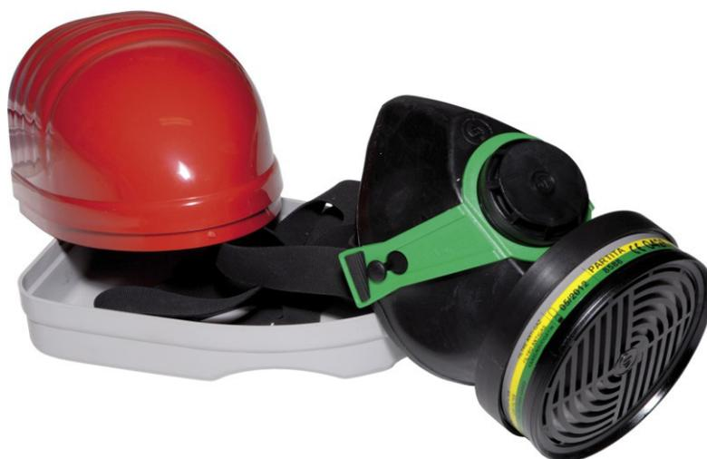
**Respiratore di emergenza** a filtro, per la fuga da ambienti o aree industriali in caso di inquinamento da gas o vapori tossici. Di tipo **ABEK** per almeno **15 min.** (DIN 58647-7). Non offre protezione da polveri o fumi né da ossido di carbonio: non è quindi adatto per l'emergenza "incendio".
