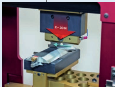
Macchinario per test di resistenza al taglio in accordo con la norma ISO 13997
