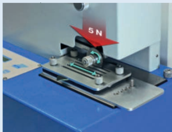
Macchinario per test di resistenza al taglio in accordo con la norma EN 388:2003
