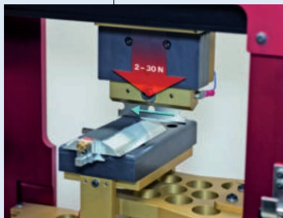
Macchinario per test di resistenza al taglio in accordo con la norma ISO 13997
